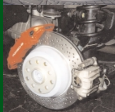
Belső hűtésű, 4-dugattyús Porsche 968 fékrendszer ABS-sel, mind a 4 keréken
